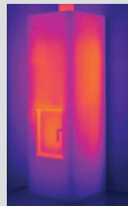
12 hod. od zatopení Průměrná teplota povrchu 45 °C
